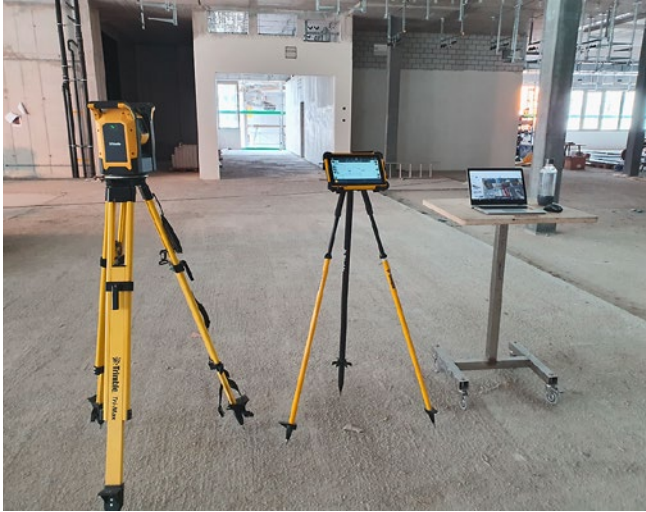
[FIG. 1] Equipement sur le chantier : tachéomètre et ordinateur portable sur une table mobile (source : Müller Wüst AG).
